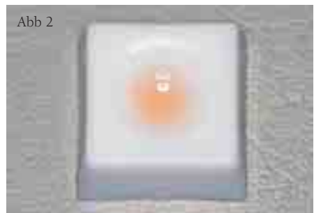
Der gerade aktivierte Haftvermittler. Die korrekte Vermischung der zwei unterschiedlichen Flüssigkeiten kann eindeutig an dem rosafarbenen Farbumschlag erkannt werden.
